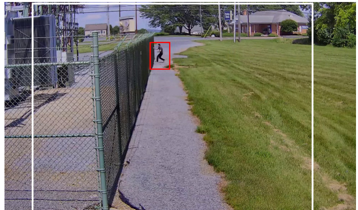
El borde blanco indica la zona de detección térmica
