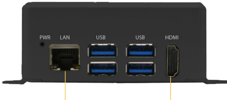
Mit Gigabit-Ethernet-Unterstützung kann die Senstar Edge-Plattform Safe Spaces-Videoanalysen für bis zu 6 hochauflösende Netzwerkvideostreams ausführen
