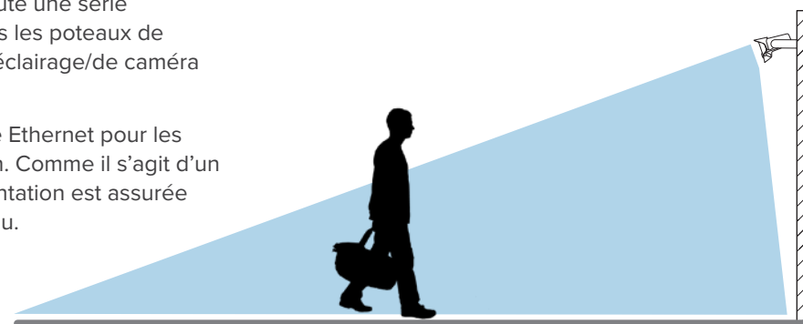
Le Senstar MultiSensor est installé incliné vers le bas à un angle de 20°, à une hauteur de 2,4 à 3,7 m (8 à 12 pieds) au-dessus du sol.
