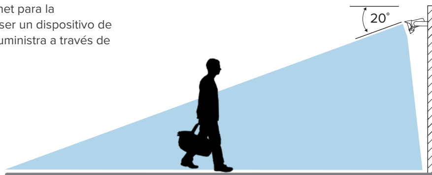
Senstar MultiSensor se instala inclinado hacia abajo en un ángulo de 20°, de 2.4 a 3.7 m por encima del suelo.
