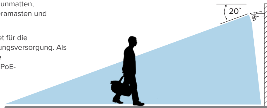
Senstar MultiSensor wird in einem Winkel von 20° nach unten geneigt und zwischen 2,4 bis 3,7m über dem Boden installiert.
