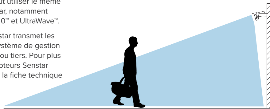
Le Senstar MultiSensor Cascade Plus est installé incliné vers le bas à un angle d'environ 20°, à une hauteur comprise entre 2,4 et 3,7 m (8 à 12 pieds) au-dessus du sol.
