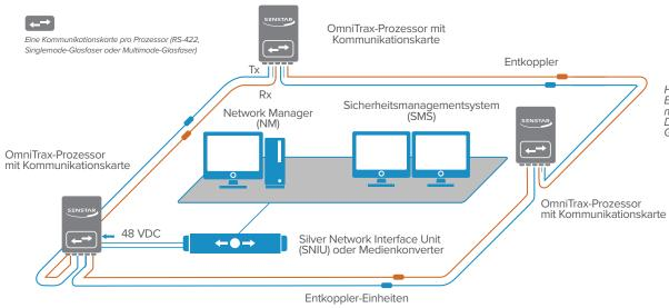
Hinweis: Es dürfen die Sensorkabel von nicht mehr als 5 Prozessoren über Entkoppler elektrisch verbunden sein (in jeder Gruppe von bis zu 5 Prozessoren müssen an jedem Ende der Gruppe Abschlusswiderstände installiert sein). Datenkommunikationsschleifen werden über Glasfaserkommunikationskabel von Gruppe zu Gruppe über zusätzliche Gruppen erweitert.
