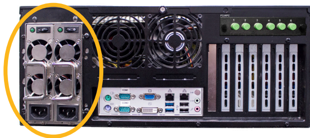
Zwei redundante, Hot-swap-fähige Netzteile
